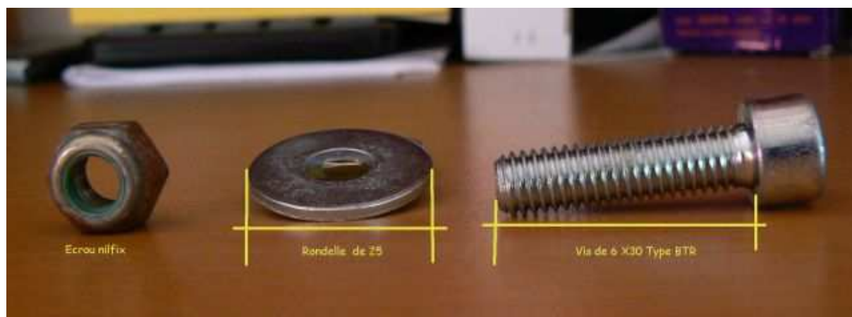
Boulon et écrou achetés séparément : rondelle de 25 mm et boulon BTR de 6x30 mm
