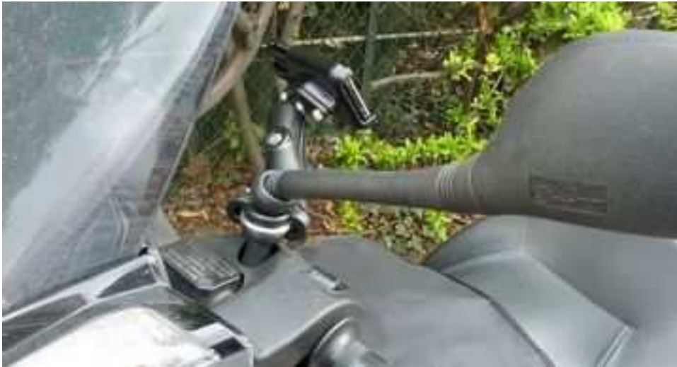
Adaptateur pour guidon (RAP-319U) + Base U pour guidon (RAM-B-231) + Bras fixation articulé (RAM-B-201U) + Base Losange (RAM-B-238) + Berceau RAM Apple iPhone (RAM-HOL-AP6U) + iPhone [Vue de derrière]
