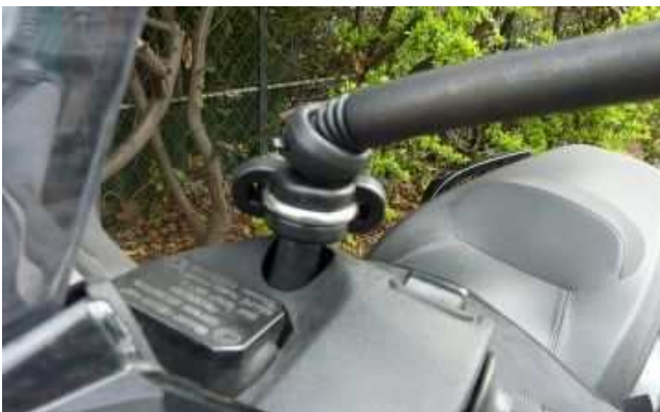
Adaptateur pour guidon (RAP-319U) + Base U pour guidon (RAM-B-231) [Vue de derrière]
