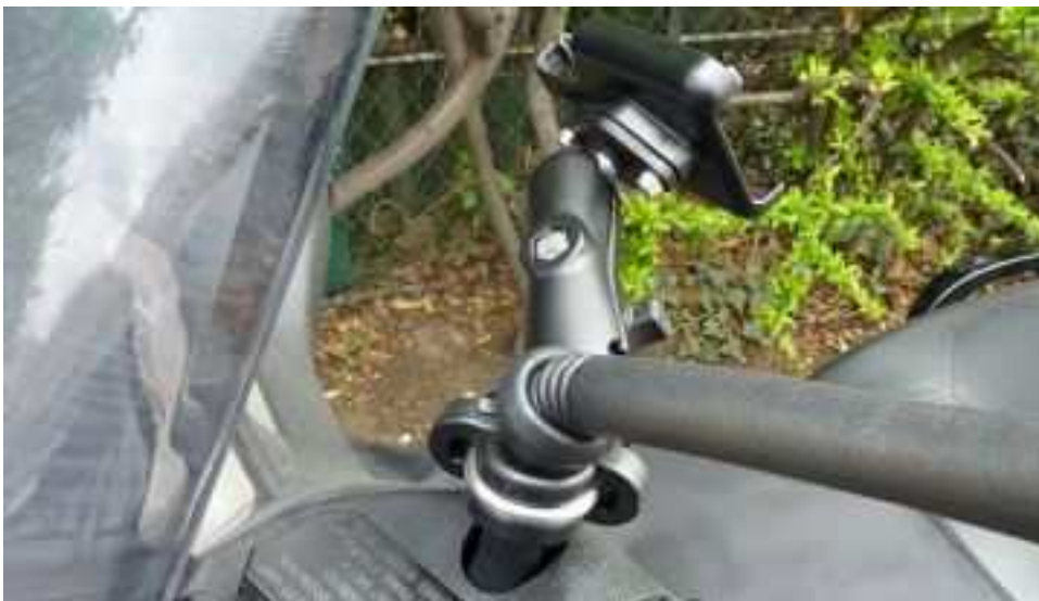
Adaptateur pour guidon (RAP-319U) + Base U pour guidon (RAM-B-231) + Bras fixation articulé (RAM-B-201U) + Base Losange (RAM-B-238) + Berceau RAM Apple iPhone (RAM-HOL-AP6U) [Vue de derrière]
