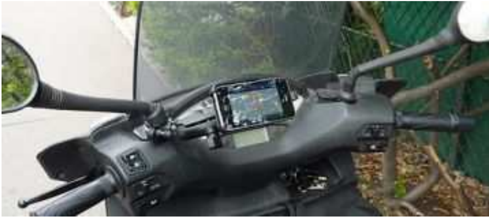
Adaptateur pour guidon (RAP-319U) + Base U pour guidon (RAM-B-231) + Bras fixation articulé (RAM-B-201U) + Base Losange (RAM-B-238) + Berceau RAM Apple iPhone (RAM-HOL-AP6U) + iPhone
