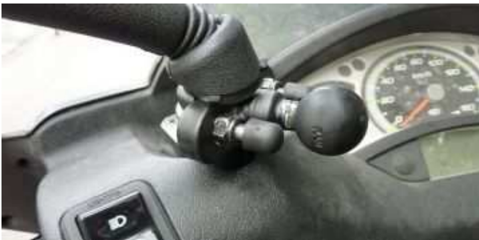
Adaptateur pour guidon (RAP-319U) + Base U pour guidon (RAM-B-231) [Il suffit de relever légèrement la gaine de protection afin de positionner le U. Cela ne l'altère pas. Lorsqu'il s'agira de le retirer, il suffira de repositionner la gaine]
