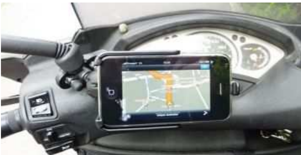
Adaptateur pour guidon (RAP-319U) + Base U pour guidon (RAM-B-231) + Bras fixation articulé (RAM-B-201U) + Base Losange (RAM-B-238) + Berceau RAM Apple iPhone (RAM-HOL-AP6U) + iPhone [Position de conduite]
