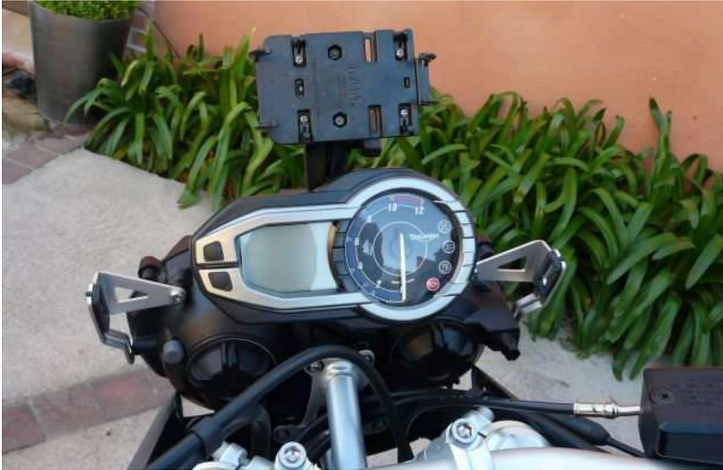
Vue avant de l'ensemble de fixation complet sans le Smartphone/GPS
