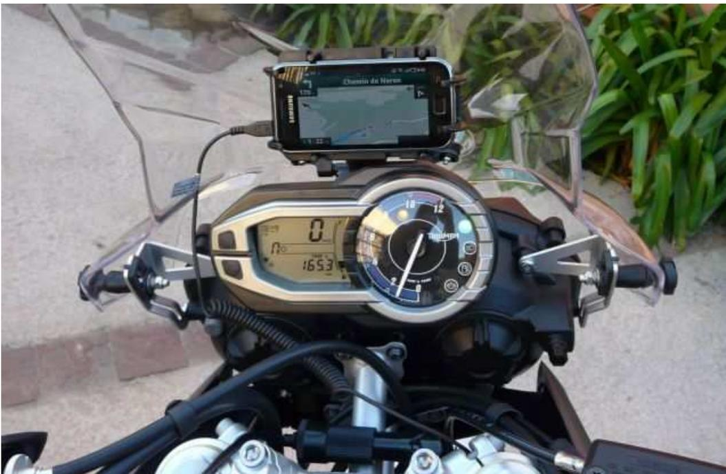
Vue avant de l'ensemble de fixation complet avec le Smartphone/GPS
